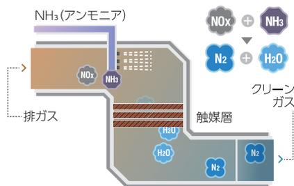
排ガスにアンモニアを注入し、触媒層の作用で化学変化を促進させ、窒素酸化物を無害な窒素と水に分解する
