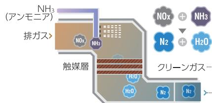
排ガスにアンモニアを注入し、触媒層の作用で化学変化を促進させ、窒素酸化物を無害な窒素と水に分解する
