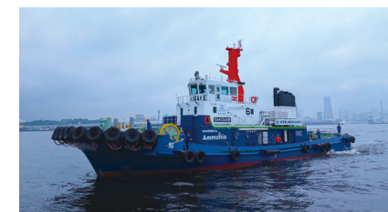
アンモニア燃焼エンジン搭載タグボート
