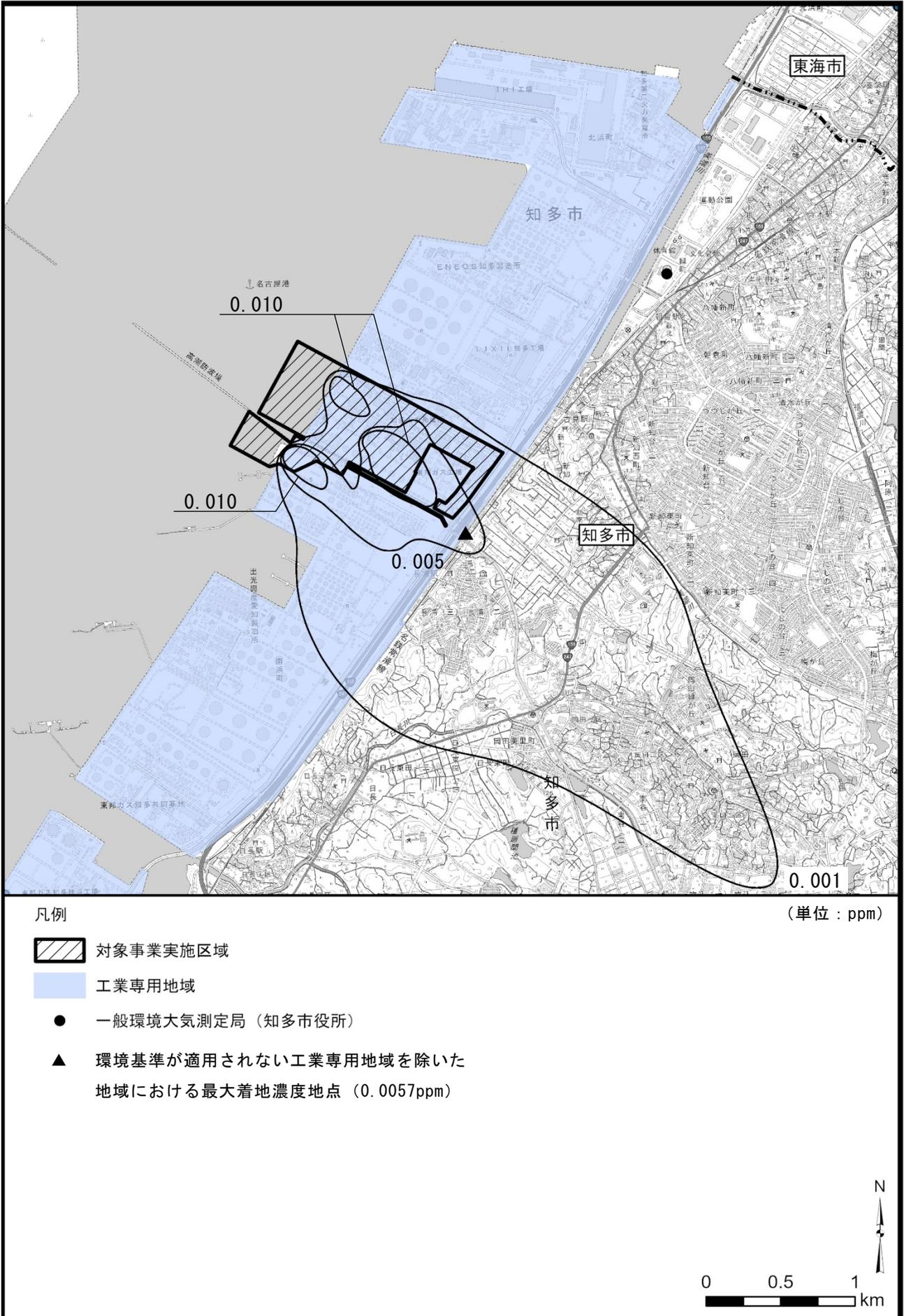
図 2-3 建設機械の稼働に伴う浮遊粒子状物質日平均値の予測結果
