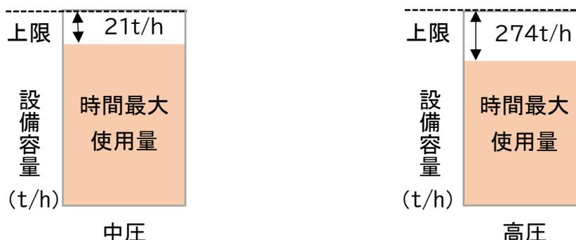
(注) 上図は、LNG気化設備の時間最大使用量をイメージで表したものです。
