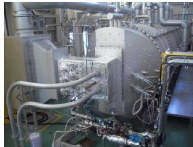
アンモニア燃焼試験設備 (0.5トン/時燃焼試験炉)
